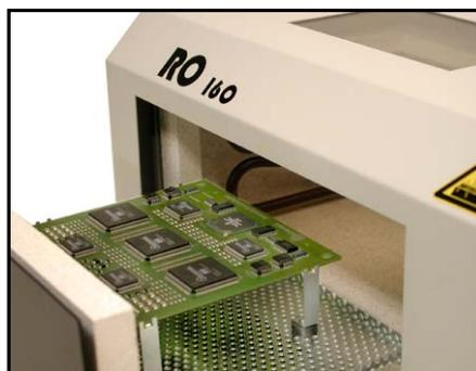
Die Halter für die Leiterplatte sind mit Magnetfüßen ausgestattet und können beliebig auf der Schubladenfläche verschoben werden. Die Leiterplatte wird im Luftstrom ohne thermische Belastung gehalten und gleichmäßig erwärmt.
