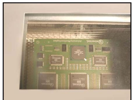
Der gesamte Lötprozess wird durch das große Sichtfenster beobachtet. Gegebenenfalls könnte sofort korrigierend eingegriffen werden. So wird bereits die erste Platine erfolgreich gelötet.
