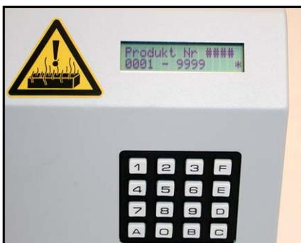
Die gewählte Zeit des Lötvorgangs kann durch drücken und halten der Taste F verlängert oder mit Taste C verkürzt werden. Die so ermittelte Zeit wird automatisch für den nächsten Lötvorgang gespeichert.
