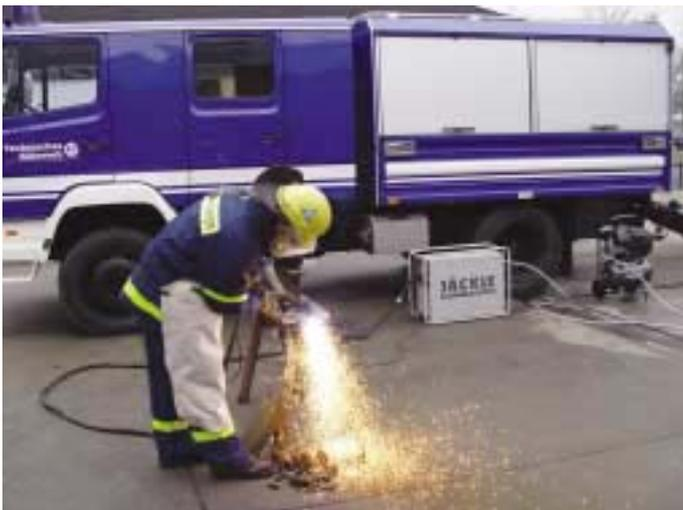
Das THW hat bereits 137 große Geräte Plasma 110 IP44 im Einsatz. Metalle bis 35 mm Stärke können schnell und mühelos getrennt werden.
