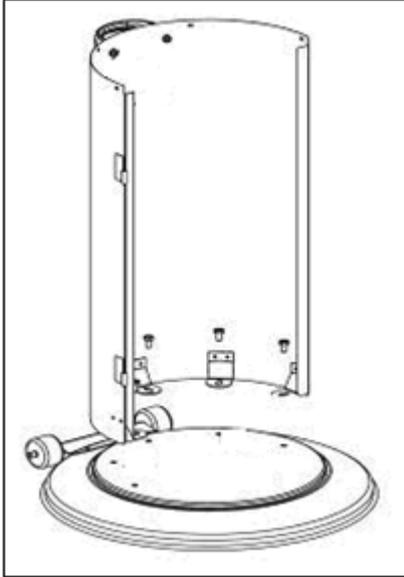
4. Befestigen Sie den kompletten Brennerkopf an der Rückwand mit 4 M4 x 10 mm Schrauben, 4 M4 Unterlegscheiben und 4 Schraubenmutter.
