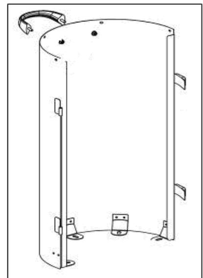
3. Befestigen Sie die Rückwand mit 5 M8x22mm Schrauben am Fuß.
