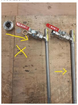
Nun die 2x Ringe und das Sieb aus den Nebellöschlanzen herausnehmen (ggf. leicht auf Tisch klopfen). Einen Ring wegwerfen, den anderen wieder in die Lanze, darauf das Sieb und dann die Festkupplung D (Außengewinde) mit Gewindesicherung festschrauben. Die Reihenfolge ist auch auf dem Bild zu sehen (rechts im Bild der fertige Artikel).
