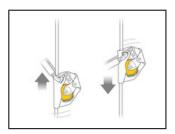
Bei normaler Verwendung läuft das ASAP ohne manuelles Eingreifen mit dem Anwender am Seil mit.
