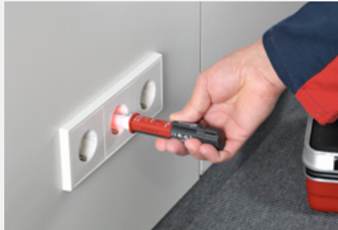
Überprüfung von Steckdosen auf Wechselspannung und Polarität
